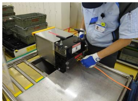
被覆剥ぎ取り
