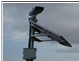
簡易型河川監視カメラ
