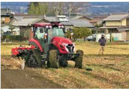
自動運転トラクタで田を耕す様子
