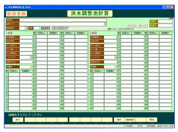
洪水調整池計算の諸元データを登録し計算結果をエクセルデータとして作成する画面です。
