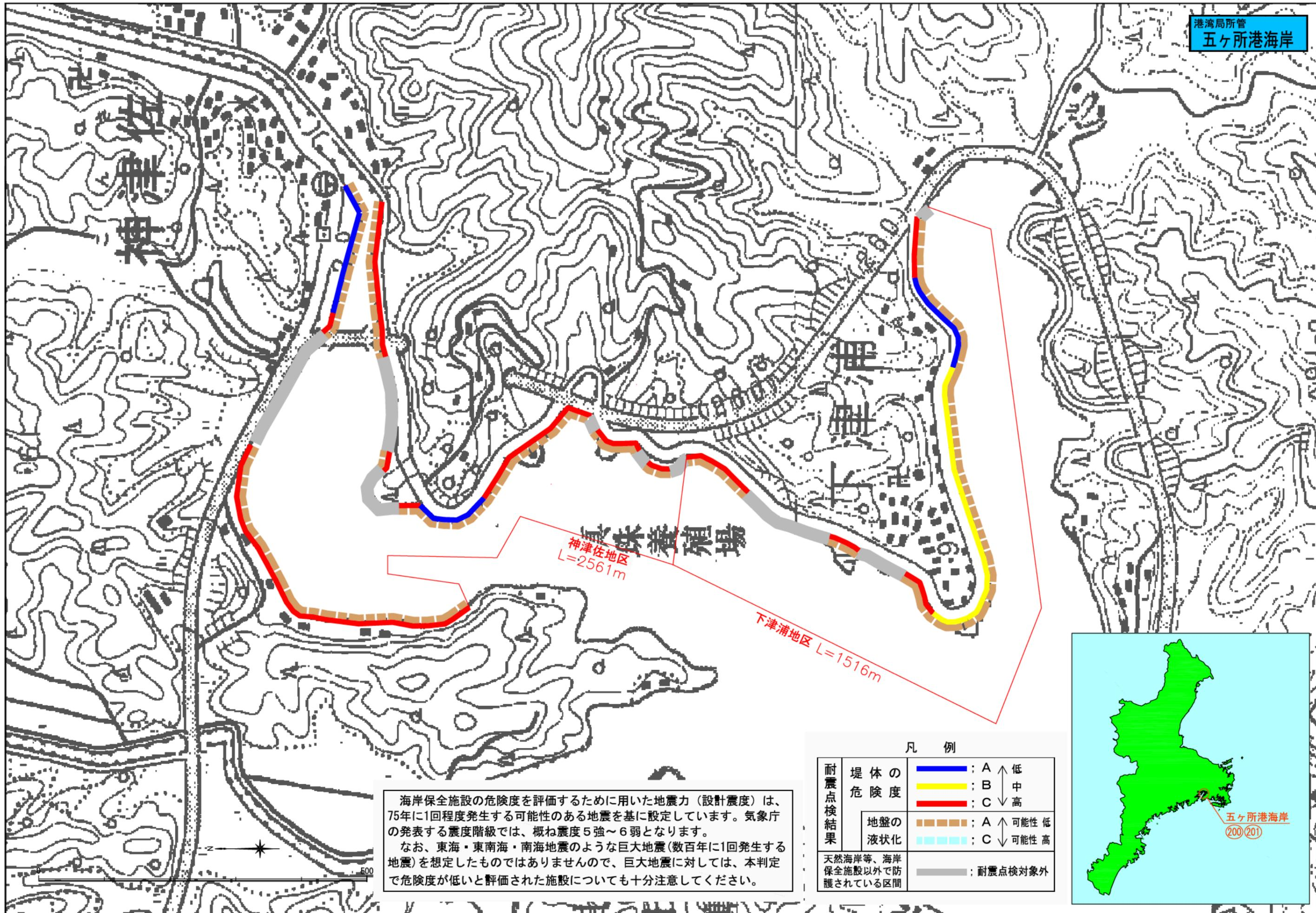
海岸保全施設の危険度を評価するために用いた地震力（設計震度）は、75年に1回程度発生する可能性のある地震を基に設定しています。気象庁の発表する震度階級では、概ね震度5強～6弱となります。
