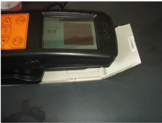
写真3 色彩色差計による測定の様子
