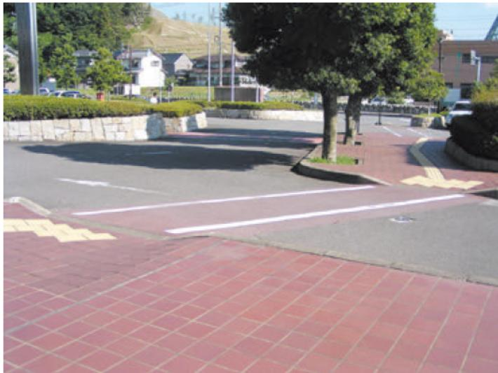
車道交差部路面に凸部を設けることで、敷地内の通路の安全な通行を確保しています。車両速度の減速効果があります。また、車道路面と敷地内通路路面の色彩の明度差を大きいものとすることで、歩行者と車両の区分がわかりやすいよう工夫されています。
