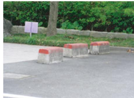
プレキャスト製の歩道境界ブロックを車止めとして利用していますが、識別しやすいように着色を行っています。
