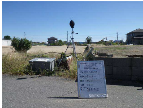
写真 2.2-1 騒音測定機器設置状況
