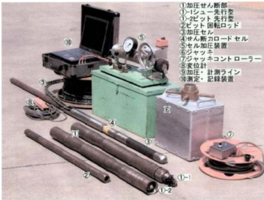
図 - 19 SB - IFT 試験装置
