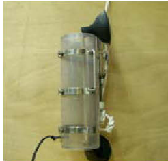
バンドーン採水器 採水量 6リットル 単式 製造元：三洋測器 (株)
