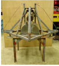
スミスマッキンタイヤ型採泥器 採泥面積：1 / 20 m 2 製造元：(株) 三洋測器
