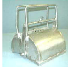
ハンド・グラブ型採泥器 採泥面積：1 / 20 m 2 製造元：芙蓉海洋開発 (株)
