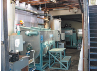
生ごみ処理品を飼料化 (ペレット化)
