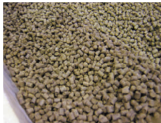
生ごみ処理品を飼料化 (ペレット化)
