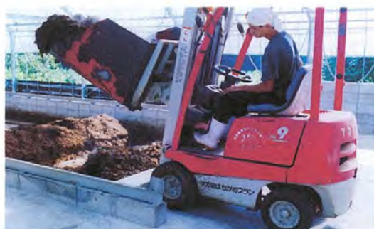
3. レーン投入 (レーン式自走醗酵マシンに投入) 初期ヤードで約1週間醗酵させ、レーン式自走醗酵マシンに投入、マシンの回転で攪拌作業により1日1m前進させる。
