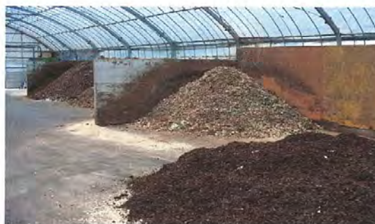
2. 初期醗酵 (1日～7日、温度は75℃に上昇) 毎日切り替えしと移動を行い、空気にふれさると微生物の働きで活発になり、湿度は一気に75℃近くまで上昇する。
