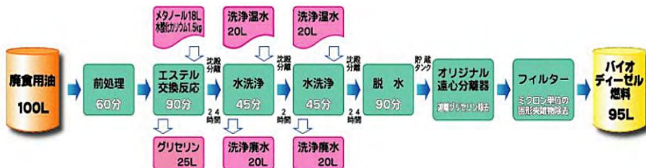
図 3-36 BDFの製造フロー
