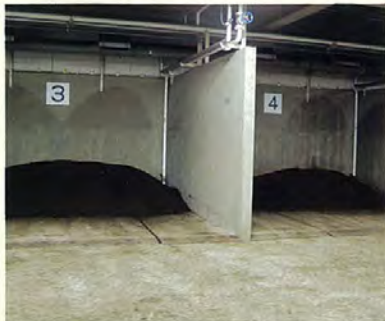
熟成貯留場 乾燥汚泥に水分を加え、散気をしながら40日貯留して熟成たい肥とします。
