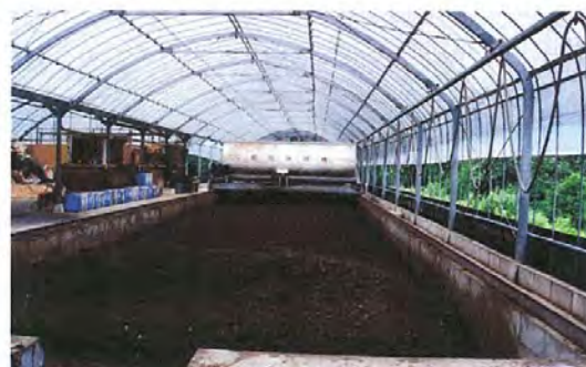
4. 中期醗酵 (7日～40日、本格的醗酵) 温度はほぼ72℃を維持、高温のため堆肥中の種子やうじ虫、大腸菌、サルモネラ菌などもこの時点で死滅する。
