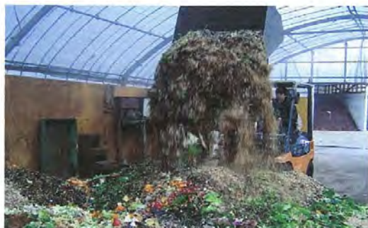
1. 混合 (生ごみ・種菌・水分調整材等を混合) 生ごみなど有機性残渣を搬入、種菌や水分調整材(もみがら、鉋屑)と混合、水分含有率を60%程度にする。
