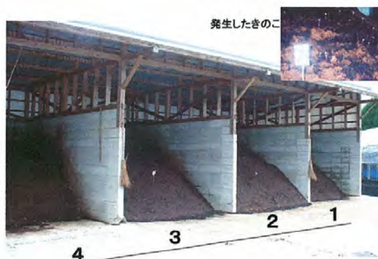
6. 熟成 ふるいにかけて堆肥を約60日間、15日ごとに切り返ししながら移動させ、熟成させる。この間、時間と共に緩やかに温度が下がる。 (1番のピットに季節によってキノコが発生するときがある)
