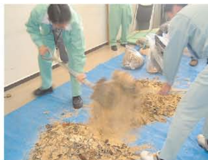
一次処理された生ごみの切り返し作業（二次処理工程）
