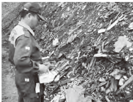
災害廃棄物の空間線量率の測定状況
