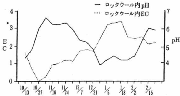
第3図 ロックウール内EC,pHの経時的变化 給液量(1 l/株/日)
