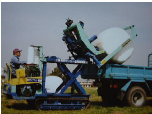
運搬車へのロールの直接荷降ろし作業
