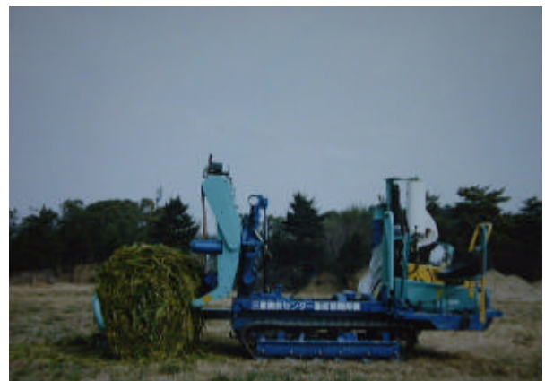
前進作業でのロール積載作業
