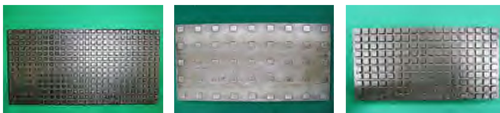
図 1 すべりにくい試験片
