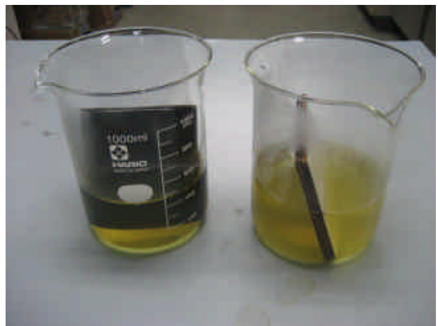
図4 半磁器質タイルの浸漬実験
