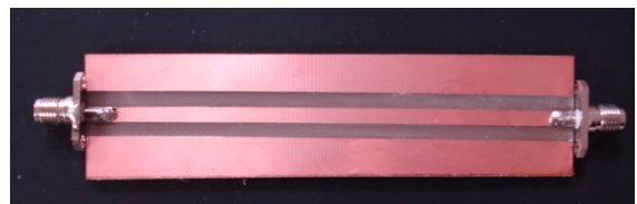
(b) マイクロストリップ線路 (隣接 GND 付き)
