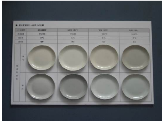
図2 低火度磁器土と一般坯土の比較
