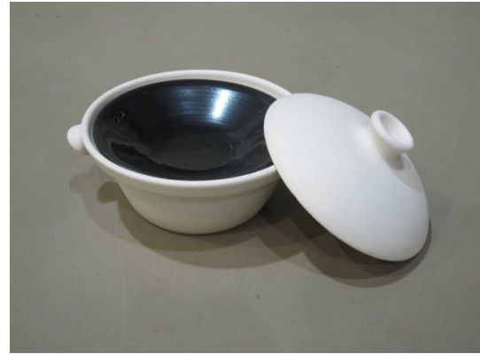
図3 マイクロ波発熱性陶磁器素地の試作
