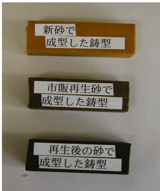
従来の市販品で行われている再生の方法より、簡単な方法(摩擦方式)で砂を再生して、従来法と同等の性能を有する再生砂が製造できることを確認しました。
