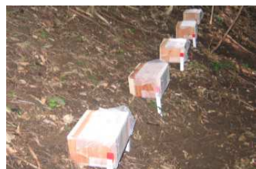
土砂受け箱を設置し、土砂流出量を継続調査
