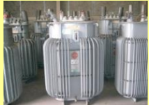
高圧トランス
