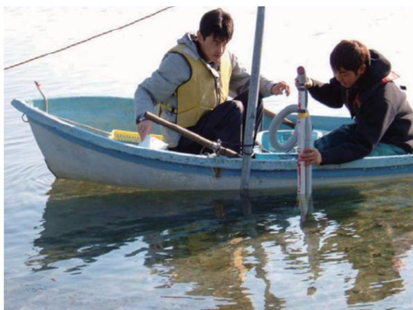
図63 シート開口部における水柱採水
