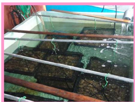
写真2. 低塩分海水養生の実証試験
