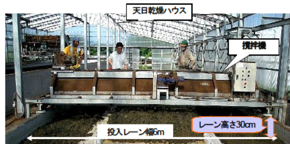
図1 汚泥の造粒システムフロー図と機械装置
