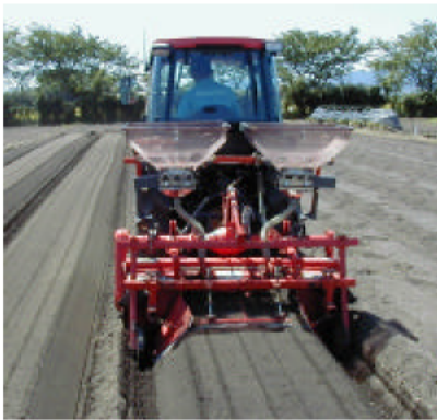
図1 被覆尿素の溶出推移 (H10) [ 成畦同時局所施肥機 (K社試作機) ]
