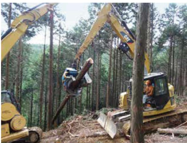
図-1. スイングヤーダとプロセッサの集材システム
