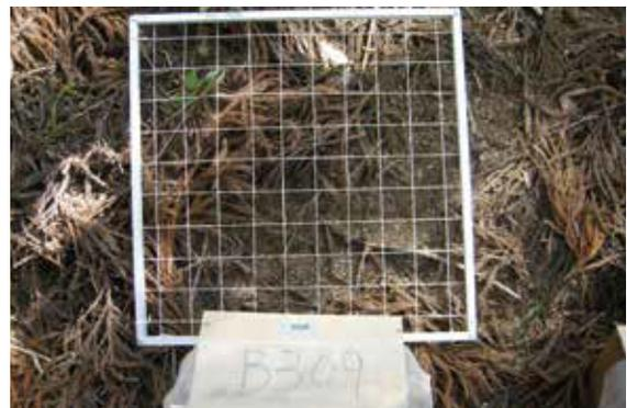
50cm×50cmの枠を置き、100個の交点の被覆状況（細土、礫、落葉落枝、植生）をカウントします。
