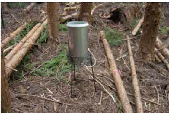
土砂移動量の調査と同時に、林内の雨量を雨量計で測定します。
