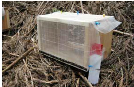
内寸で高さ15cm、幅25cm、奥行20cmの木製箱を斜面方向に対して垂直に設置します。
