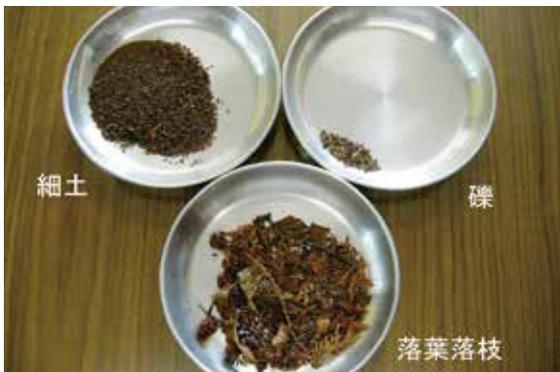
定期的に内容物を回収し、径2mm未満の細土、2mm以上の礫、有機物の3区分に分類後、乾燥して重量を測定します。
