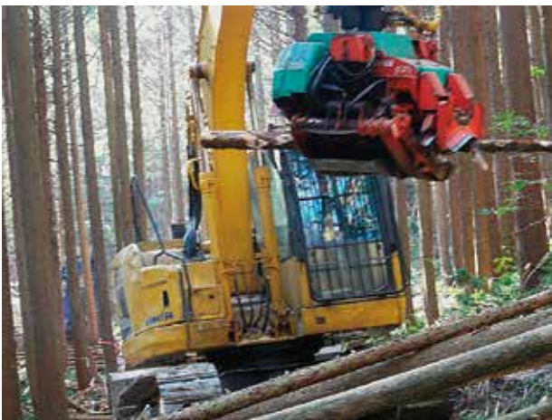
図-1. プロセッサによる造材作業
