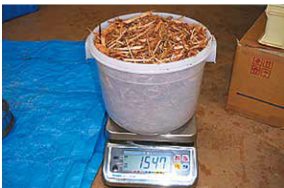
③ チップの重量を測った後、乾燥させて含水率を求めます。
