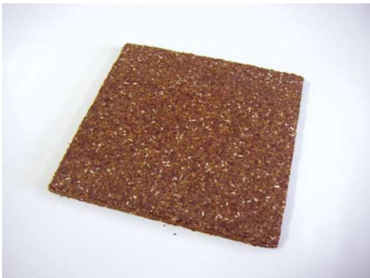
粉碎したスギ樹皮と液化した樹皮から調整した接着剤を用いた木質ボード
