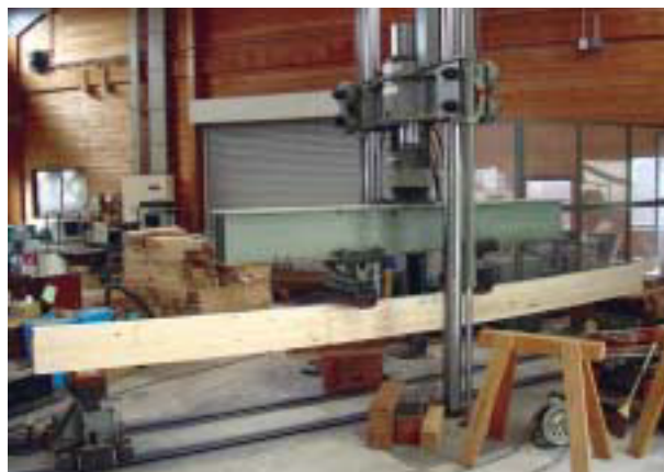
大断面集成材の曲げ強度試験
