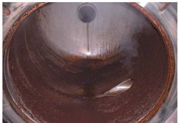
④ 爆砕処理完了（内側の茶色に見えるものが爆砕されたチップ）
