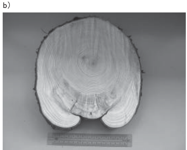
写真-2. 採取した円盤における材変色の状況. 剥皮部分から心材付近まで変色が生じている. (a) スギ. (b) ヒノキ.
