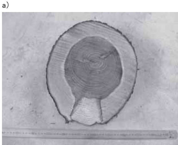
写真-2. 採取した円盤における材変色の状況. 剥皮部分から心材付近まで変色が生じている. (a) スギ. (b) ヒノキ.
