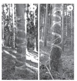
図-5. 生分解性テープの劣化が認められた処理木 処理木 a, テープが帯状に割け、その一部が切れて 樹幹表面で絡まっている;b, 地際部で切断 している. いずれも2010年1月5日(処理後 615日目)に撮影.
