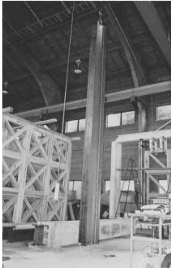
写真-2 H形鋼試験体
