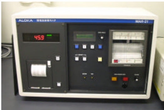
写真 - 1 モニタリングポスト測定部
