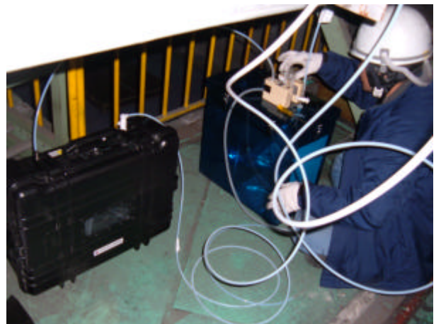
図 1 試料採取の状況 (採取容器への吸引)
