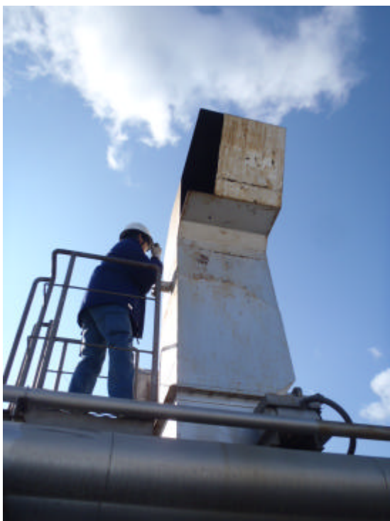
図 2 試料採取の状況（採取管の挿入）
