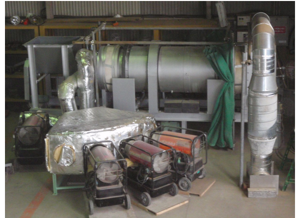
写真2 加温回転ドラムの外観。加温により、VOCや鉱物油で汚染された土壌を浄化できます。
