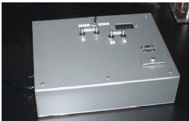
写真1 試作したUV計
