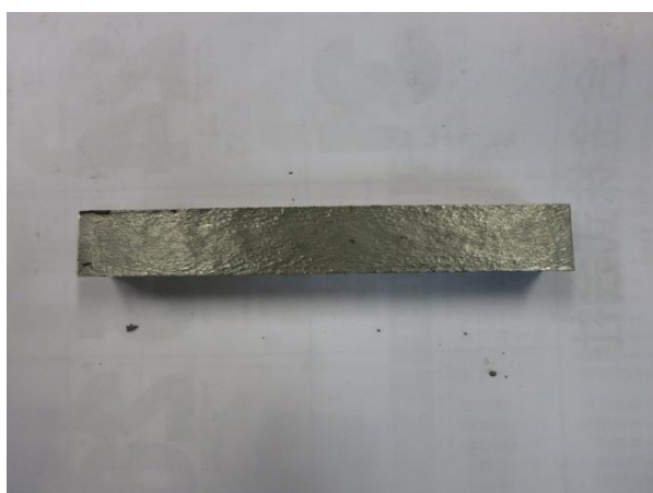
図 4 (3) 強脱酸したシェル Y ブロック試料断 窒素含有量の減少によりガス欠陥は比 較的少ない
