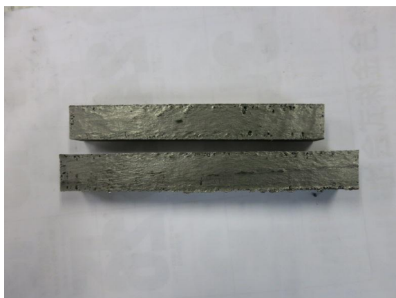
図 4 (1) 接種なしでの Y ブロック断面 (上部シェル, 下部フェノールウレタン) 両者ともガス欠陥が多発している
