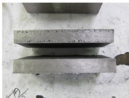
図 6 (2) 脱酸後 Y ブロック鋳型に鋳造した試料の断面 (上部フェノール, 下部 CO 2 )
