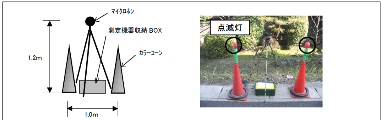
図 1-2 騒音測定機器の設置状況の例
