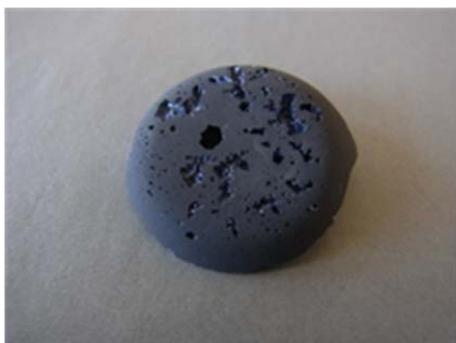
図 3 Ar 雰囲気中 1,100 °C で 4 時間熱処理後、放冷して得られた試料の外観
