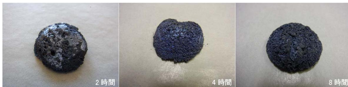
図 2 Ar 雰囲気中 1,000 °C で所定の時間, 熱処理した試料の外観図
