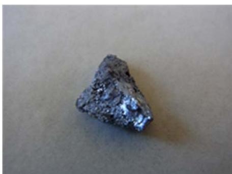
図 4 Ar 雰囲気中 1,100 °C で 4 時間熱処理後、20 °C/時で冷却して得られた試料の外観
