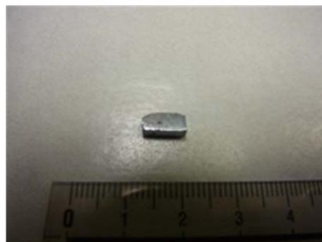
図 9 Ar 雰囲気中 1,050 °C で 4 時間熱処理後、5 °C/時で冷却し、研磨した試料の外観
