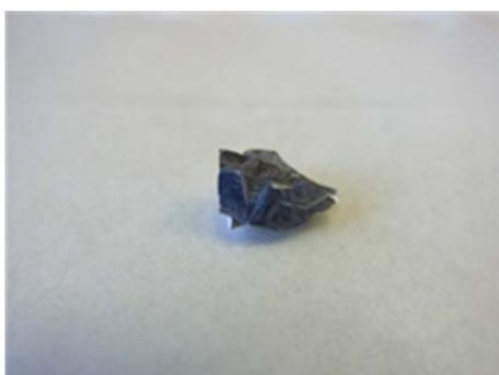
図 5 Ar 雰囲気中 1,050 °C で 4 時間熱処理後、5 °C/時で冷却して得られた試料の外観
