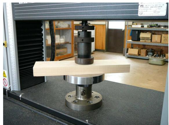
圧密処理したヒノキ材の表面硬さ測定状況
