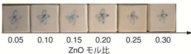
図 4 釉薬試験体の外観 (a) M 系釉薬, (b) MZ 系釉薬
