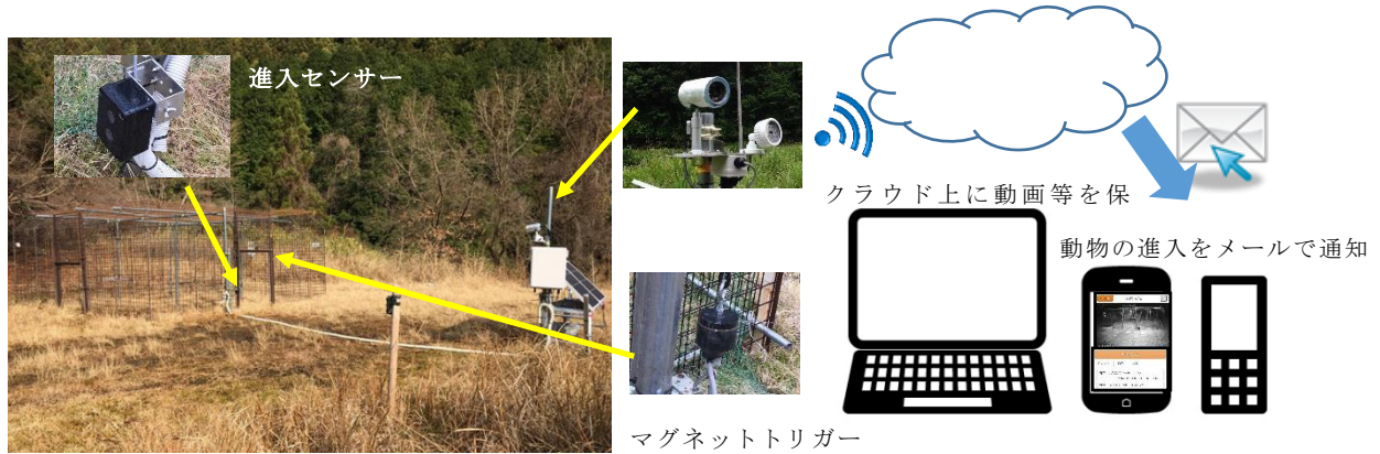
図1 クラウドまるみえホカクンの外観とシステムの概要
