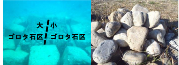
図1. 試験を実施したアワビ礁（中央部左に大ゴロタ石、右に小ゴロタ石を設置、周囲に岩）と用いたゴロタ石
