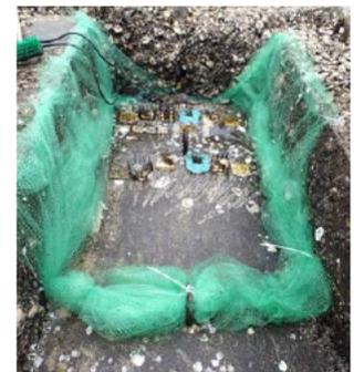
図 2. ウニ侵入防止フェンスで囲んだ試験区
