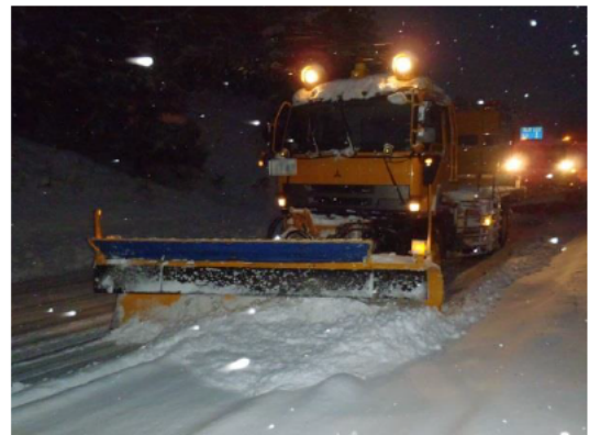
道路の除雪作業 (いなべ市)
