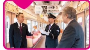
車内の木質化は、壁材の不燃処理や木製の吊り輪の耐久性を出すのに苦労したそうです。
