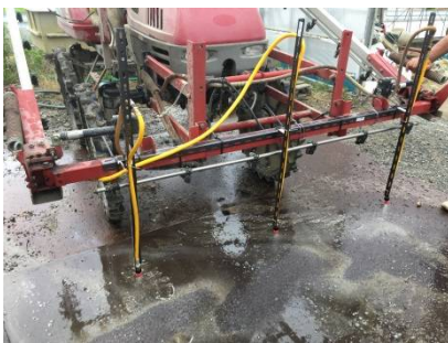
写真1 吊り下げノズル
